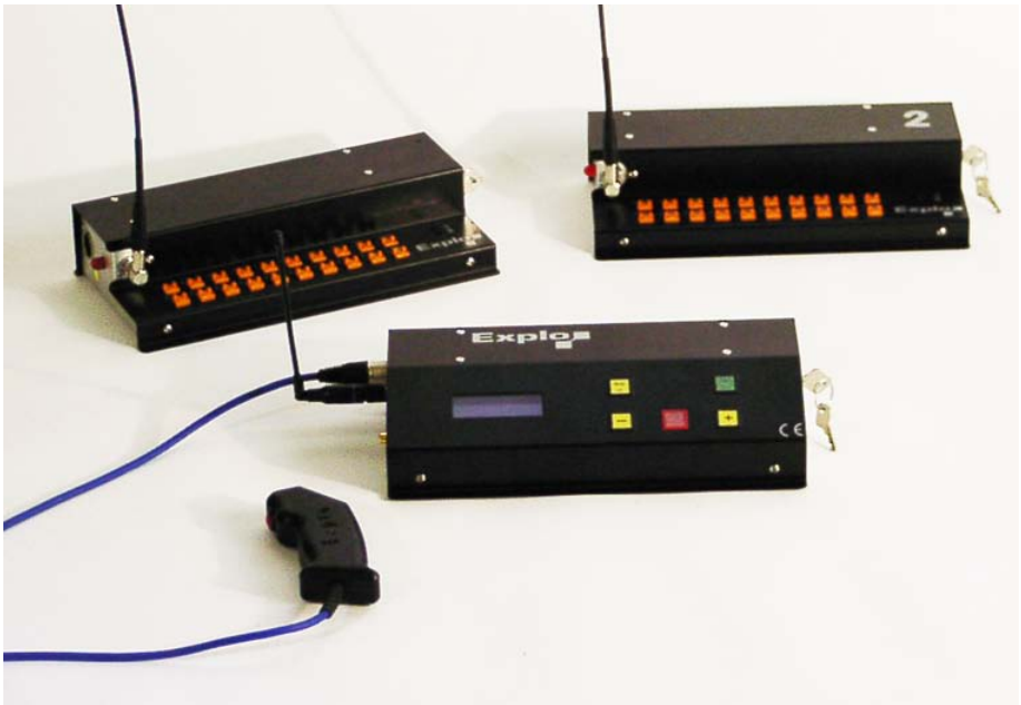
Abb. 96: Funkzündsystem: 1400 Kanäle, Typ EXPLO
