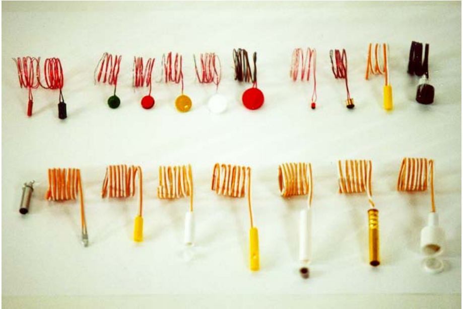
Abb. 83: Verschiedene Elektroanzünder (unten); Filmeffektzünder (oben)
