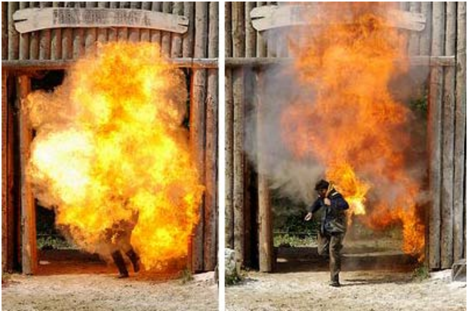
Abb. 41: Mörser mit 50 g Schwarzpulver und 300 g Lycopodium
