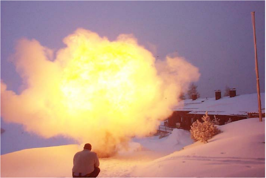
Abb. 43: Mörser mit Schwarzpulver und 15 kg Mehlstaub im Bühnenlehrgang
