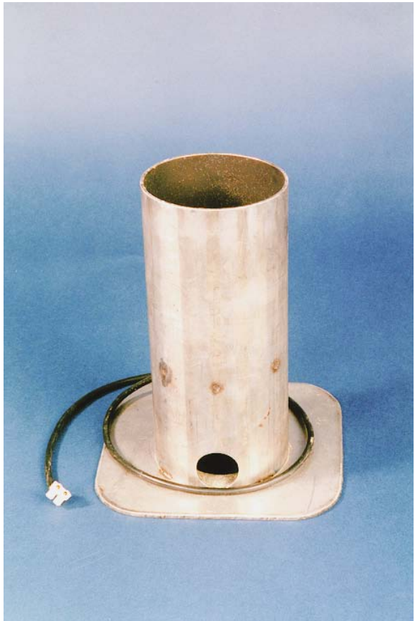
Abb. 46: Lyco-Mörser für bis zu 1 kg Lycopodium
