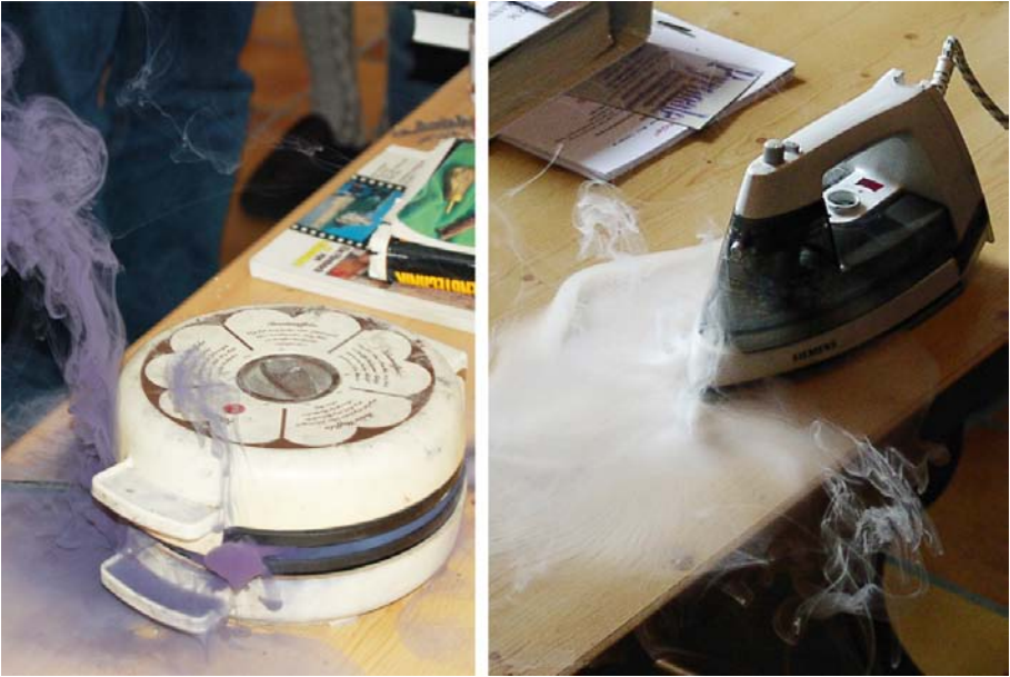
Abb. 57: Lehrgangsexperiment: Rauchtablette mit Schnellanzündschicht und etwas dunkelblauem Rauch im Waffeleisen und im Bügeleisen
