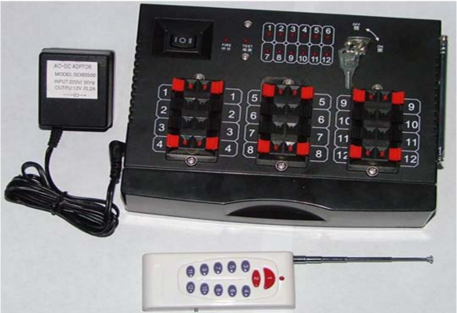
Abb. 92: oben: Abschusskästen; unten: Preisgünstige chinesische Funkzündanlage, für Anfänger bedingt geeignet
